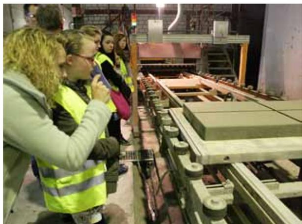
So werden also Pflastersteine aus Beton produziert.
